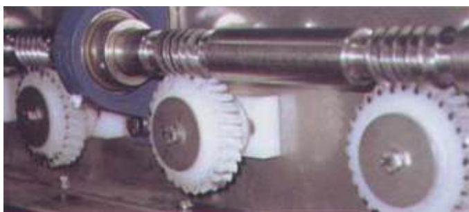
ERTACETAL - pohon dopravníku mrazicího tunelu
